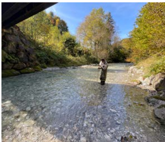
Durchflussmessung mit dem hydrometrischen Flügel*
